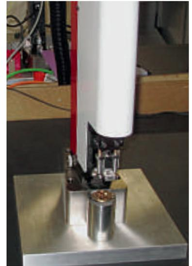
Servopresse von Stoco mit Gehäuse.
