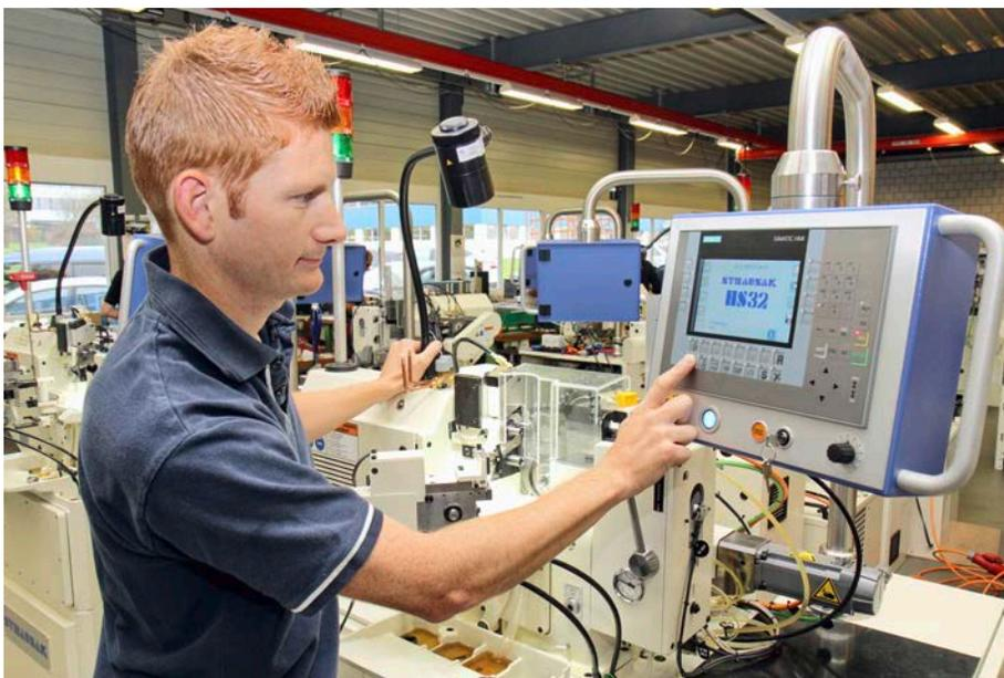
**Michael Bleuer, Leiter Entwicklung bei Strausak, an der HS32, einer kleinen, kompakten NC-Maschine mit elektronischem Getriebe und einer betriebssicheren, einfach zu bedienenden Simatic-Steuerung. Mit ihrer hohen Zuverlässigkeit ist sie besonders für den 24-Stunden-Betrieb geeignet – bei Schnittgeschwindigkeiten bis zu 1000 m/min.**
