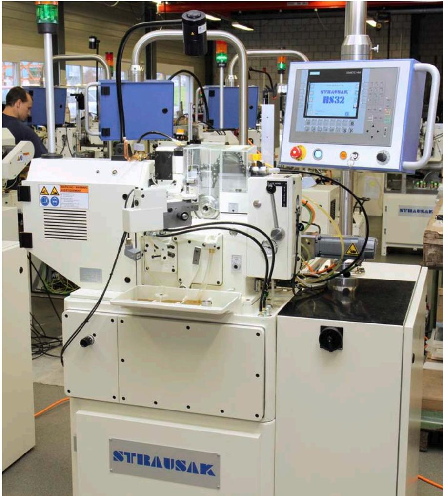
Der Aufbau der Maschine HS32 ist sehr stabil und schwingungsarm ausgelegt. Mit ihr können Verzahnungen von höchster Qualität teil-/vollautomatisch hergestellt werden.
